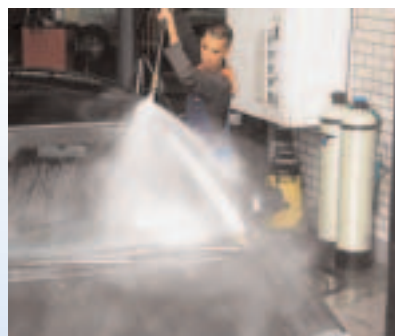
Afbeelding 5: de demiwaterinstallatie in gebruik bij het naspoelen van een auto.
