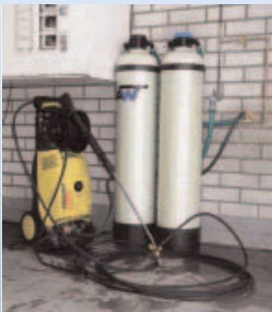
Afbeelding 4: de demiwater wisseltankset waarop een hogedrukreiniger is aangesloten.
